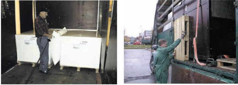
Fotografija 8: Namenske zračne blazine in palete kot polnilni material (Vir: Loading and securing cargo on/to vehicles)
