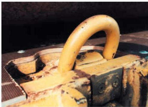
Fotografija 5: Točke za pritrjevanje za bistveno različno obremenitev
