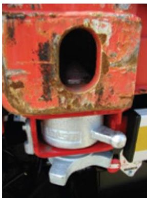
Fotografija 7: Vrtljiv zaklep »twist-lock« z zabojnikom
