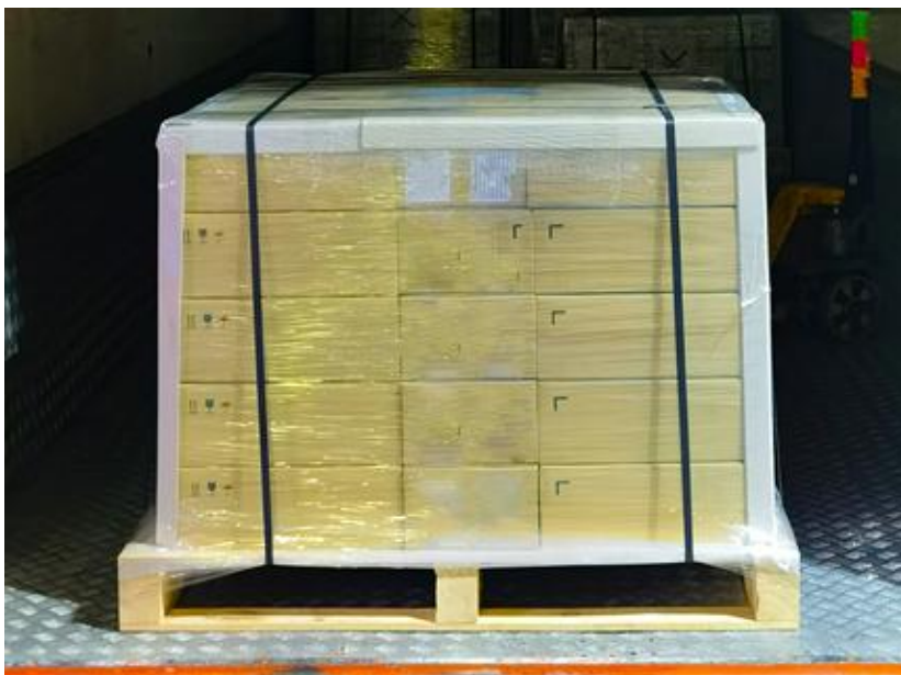
Fotografija 14: Tovor na paleti, pritrjen s kombinacijo raztegljive folije in jeklenih trakov ter zaščiten z robnimi profili
