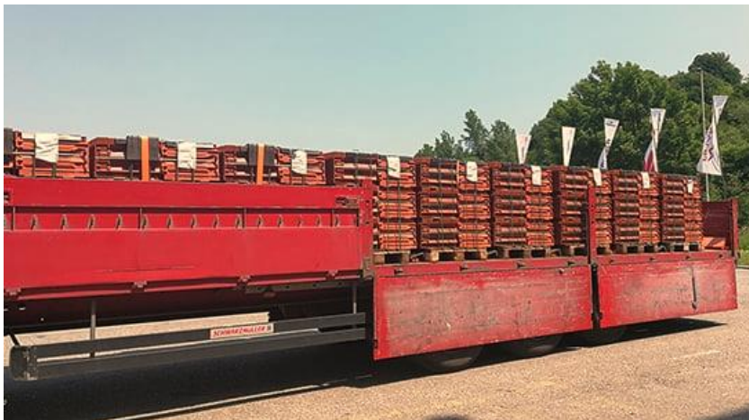
Fotografija 9: Blokiranje po celotnem tovornem prostoru
