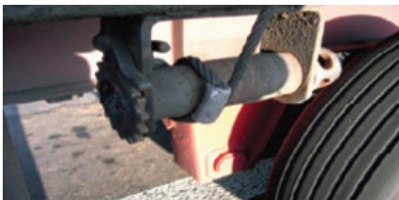
Fotografija 12: Jeklena žična vrv, napeta z vitlom
