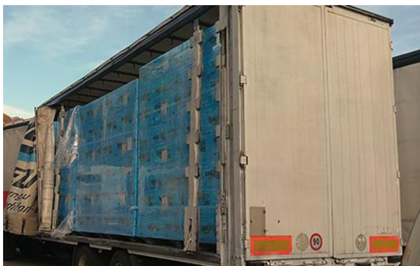
Fotografija 1: Keson s stebrički za namestitev vmesnih prečk za pritrditev tovora
