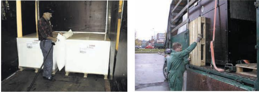
Fotografija 7: Namenske zračne blazine in palete kot polnilni material (Vir: Loading and securing cargo on/to vehicles)
