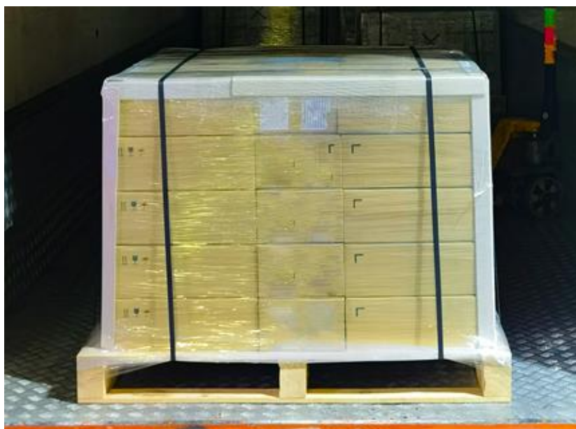
Fotografija 12: Tovor na paleti, pritrjen s kombinacijo raztegljive folije in jeklenih trakov ter zaščiten z robnimi profili
