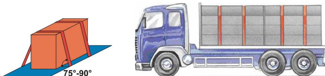
Risba 6: Privezovanje prek tovora (Vir: Pravilnik o nakladanju in pritrjevanju tovora v cestnem prometu)
