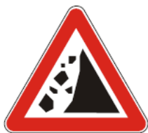
Kamenje pada na vozišče (1114)
